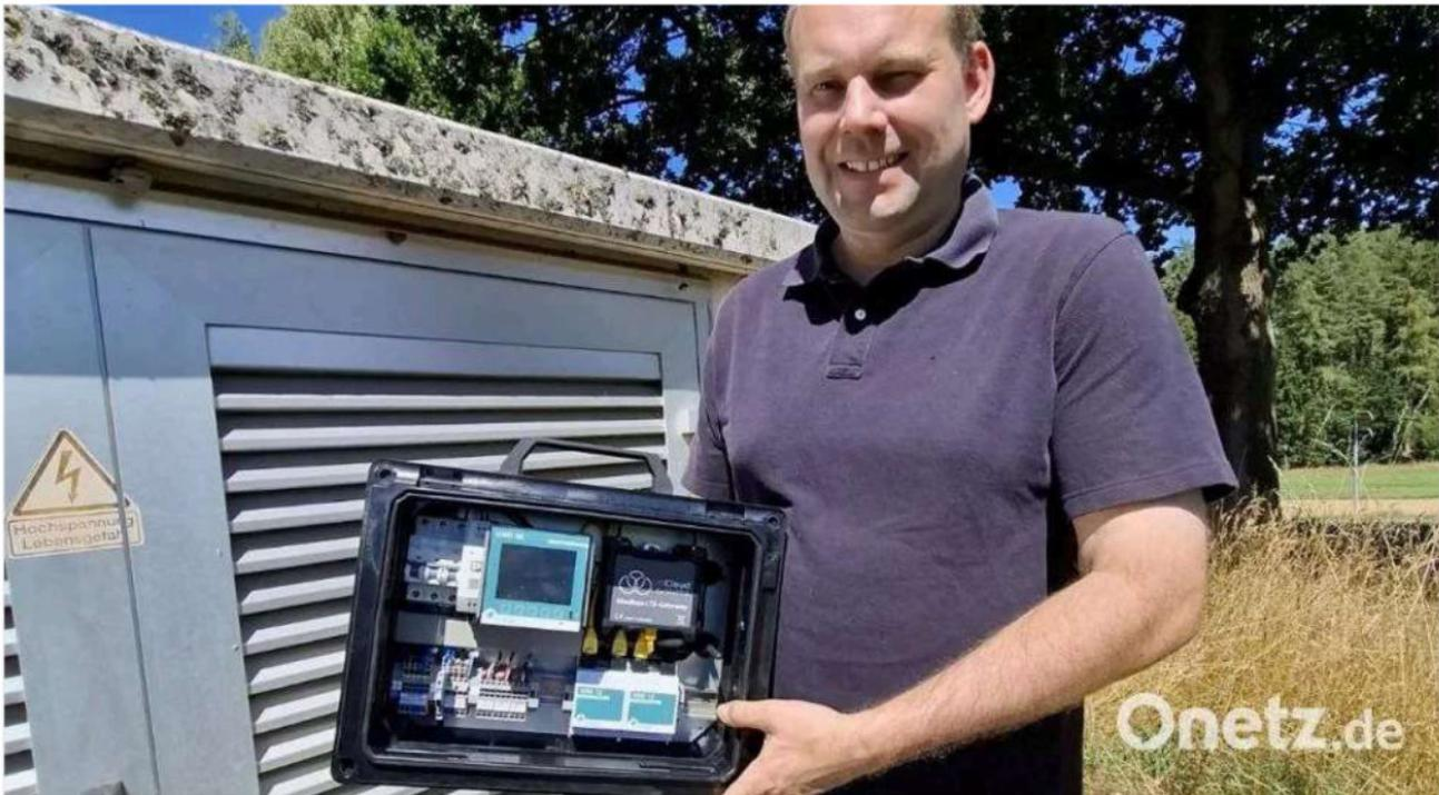
*Dr. Sebastian Baumgartner mit einem von seiner Firma selbst entwickelten Steuergerät, das zur Volldigitalisierung von Trafostationen verwendet wird.*
